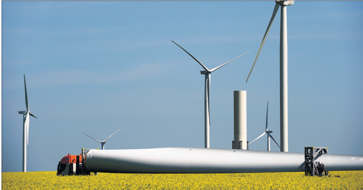
Der Windpark Fintinele in Rumänien wird nach Fertigstellung der größte Onshorewindpark Europas sein. 240 Windgeneratoren mit einer Gesamtleistung von 600 MW speisen in das Stromnetz des Landes ein. Pro Anlage sind zwölf Schwer- bzw. Großraumtransporte vom Hafen bis zur Baustelle nötig. Hier der Transport eines fast 50 m langen Rotorblatts. Foto: GE
